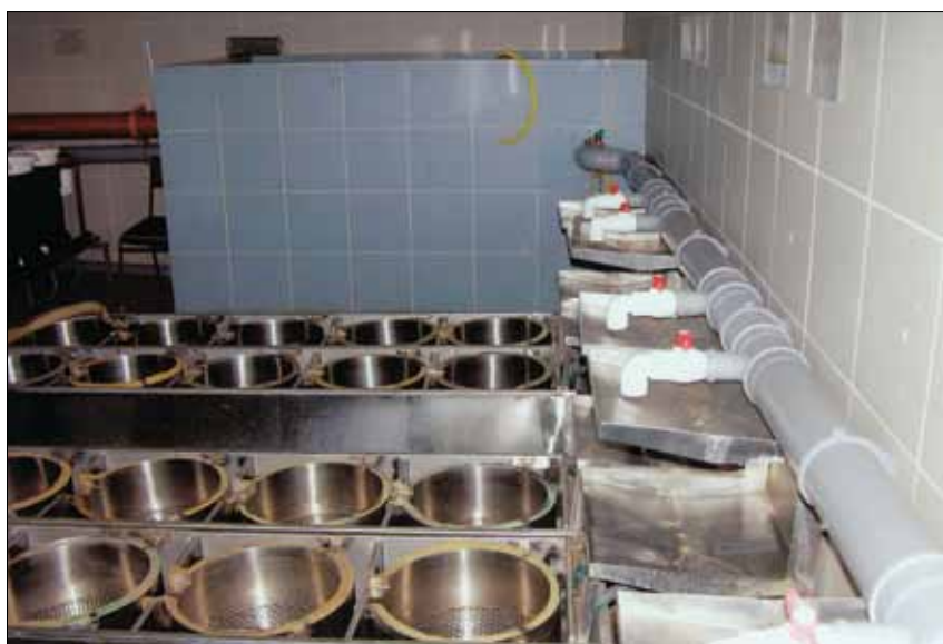
Ryc. 7. Zmodyfikowane nowoczesne aparaty do inkubacji ikry i podchowu wylęgu
